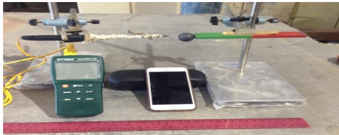
الشكل (8). يوضح صورة للإعداد التجريبي المستخدم لتحديد درجة حرارة كوري من كور فيرو مغناطيسية يتم إدخال طرف المزدوج الحراري من النوع K في ثقب صغير في الكرة، لقياس درجة حرارتها.
