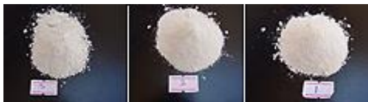
شكل (3) مسحوق العينات الثلاثة بعد عملية الخلط والمزج والطحن.
