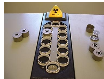
شكل (9) جهاز حيود الأشعة السينية وكيفية إدخال العينة به لإجراء عملية الكشف وتحديد عناصرها.
