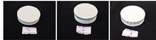
شكل (8) شكل العينات التي تم إعدادها بواسطة جهاز الكبس لإدخالها في جهاز الأشعة السينية.
