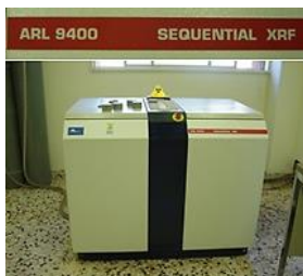
شكل (13) جهاز حيود الأشعة السينية الذي تم استخدامه في تحليل العينات (ARL 9400 SEQUENTIAL XRF).
