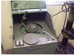
شكل (12) الجهاز المستخدم في تفتيت المعادن وطحنها ليسهل إعداد منها مسحوق العينة.
